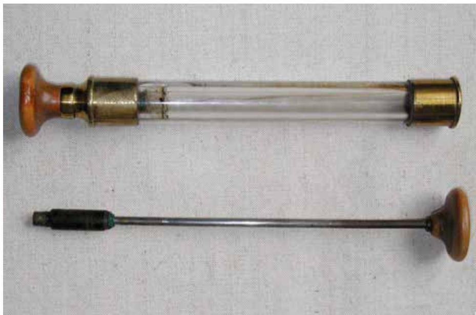
Des briquets adiabatiques étaient utilisés au XIX e siècle, comme objet de démonstration pour les cours de Physique.
